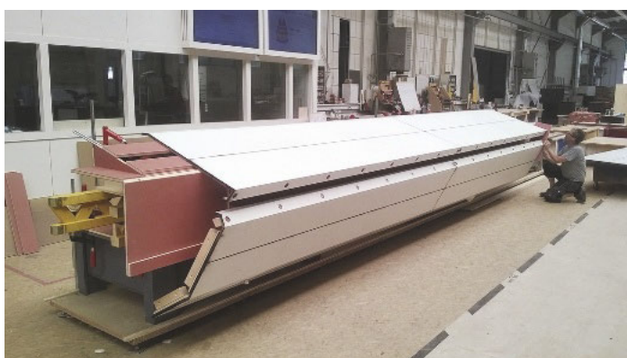
/ Verpackungskunst: Für die sichere Lieferung der bis zu 5,80 m langen Bauteile wurden bei Werk 33 eigens passende Transportvorrichtungen gebaut.
